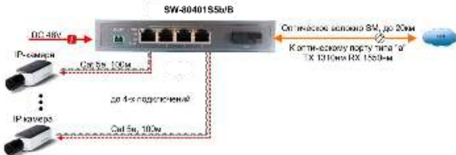
Рис. 3 Схема подключения коммутатора SW-80401S5b/B
