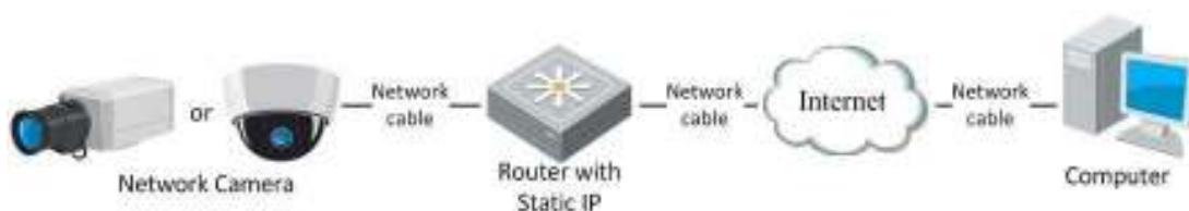
Рисунок 2-4 Доступ к видеокамере через роутер со статическим IP- адресом
