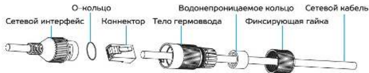
Рисунок 6. Установка гермоввода
