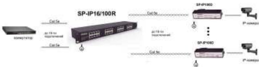
Рис. 12 Схема подключения SP-IP4/100, SP-IP8/100(ver.2), SP-IP8/100R, SP-IP16/100R, SP-IP24/100R на примере SP-IP16/100R
