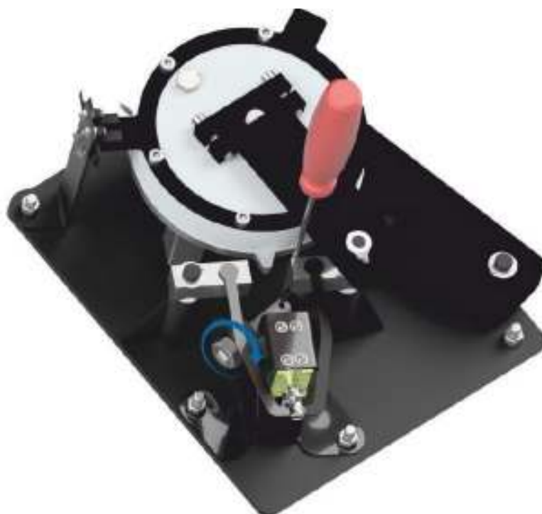
Рисунок 12.4.1 – Регулировка натяжения пружины доводчика
