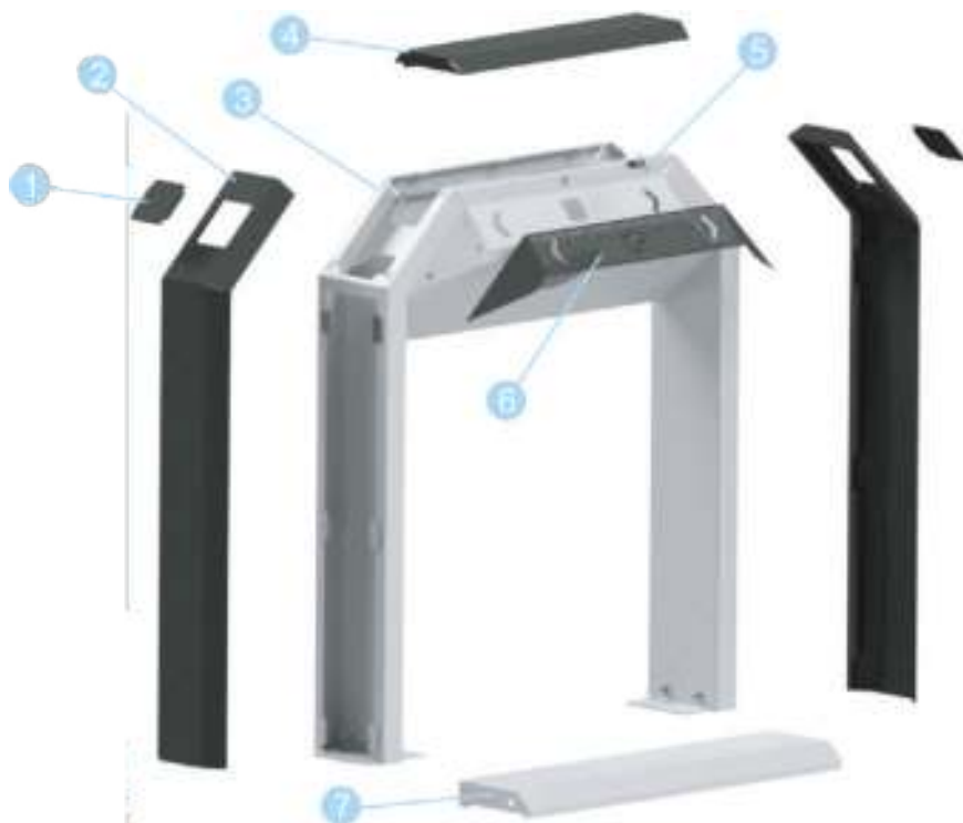
Рисунок 6.1.1. – Элементы корпуса турникета «STR-03»
