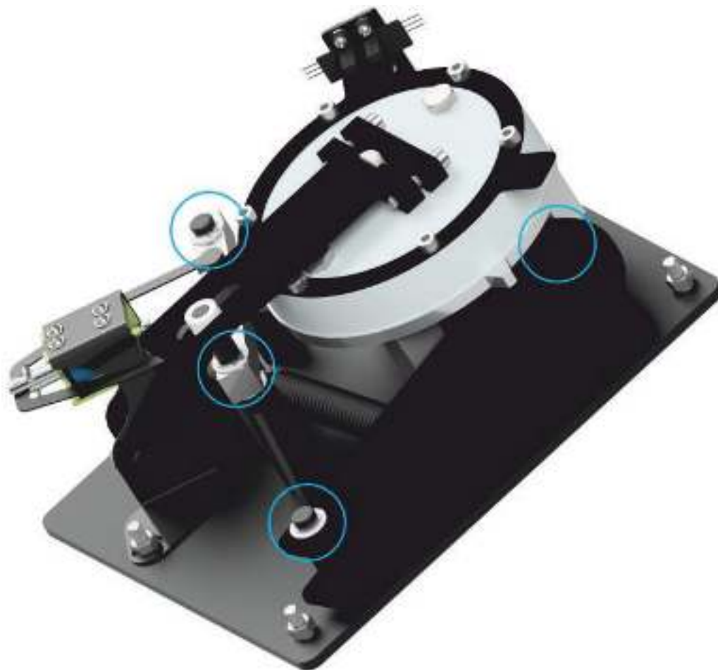
Рисунок 12.5.1 – Места смазки подвижных частей
